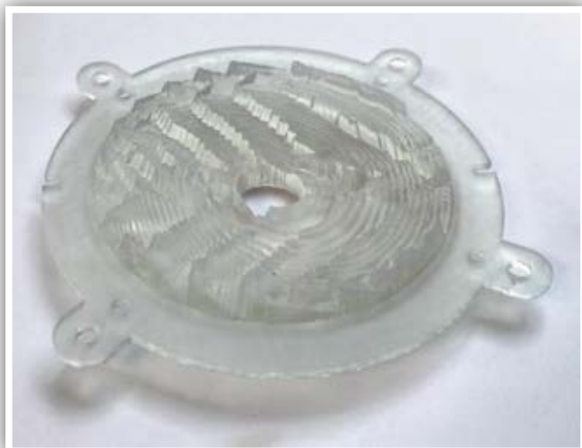
Figura 3. Fotografía de la lente holográfica construida para focalizar en el hipocampo.
